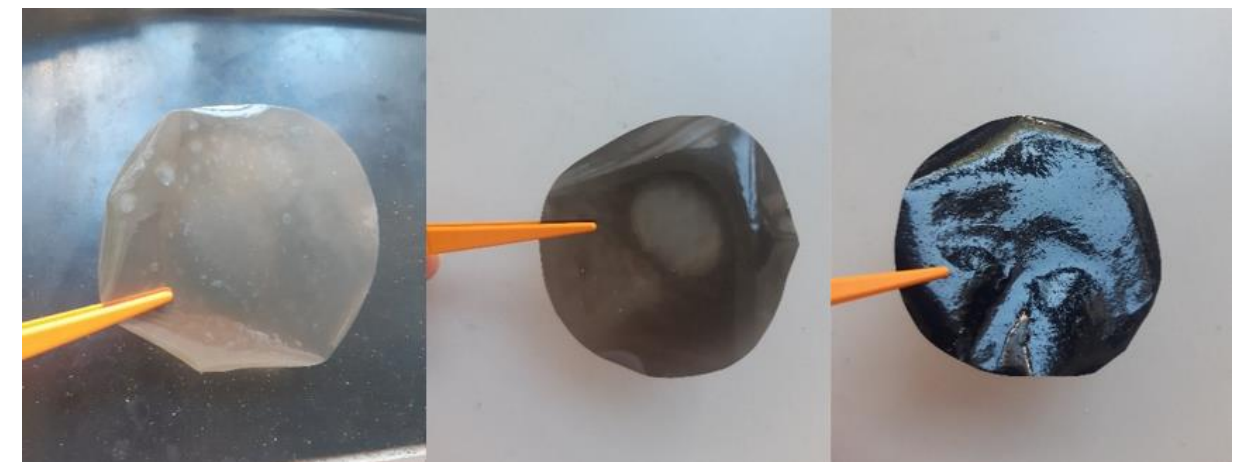
Rys.1. Folie PVA z CNTs syntezowane metodą suchą (od lewej z dodatkiem 0,01% CNTs, 0,10% CNTs oraz 1,00% CNTs).
